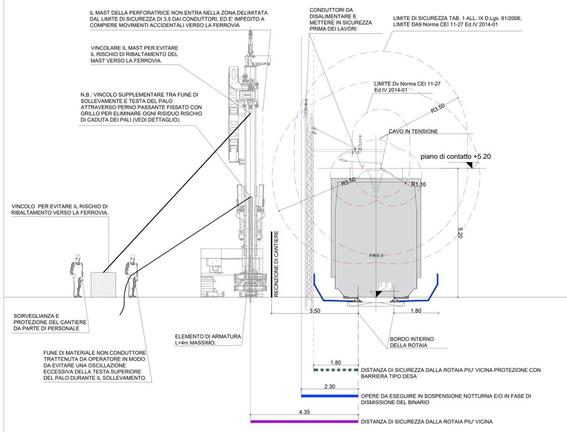
**SEZIONE TIPICA: DISTANZE MINIME DI LAVORO IN CASO NON SI PRENDANO PRECAUZIONI PER EVITARE LA CADUTA DELLE ARMATURE DEI PALI MOVIMENTATE**
