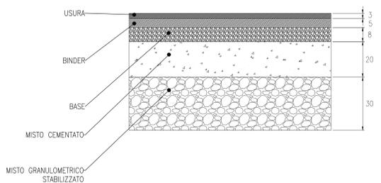
LO SCHEMA DELLA PAVIMENTAZIONE STRADALE ADOTTATO È CONFORME CON IL CATALOGO DELLA PROVINCIA DI BOLZANO, DAL QUALE IL PACCHETTO È STATO PRESO DIRETTAMENTE.
