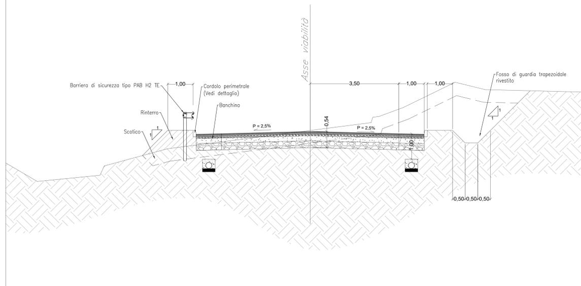
RAMI DI ACCESSO – SEZIONE IN RILEVATO
