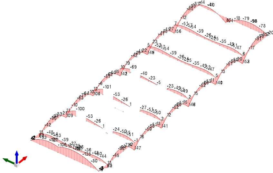
Fig. 44. Diagramma momento flettente M travi di fondazione (involuppo SLE-qp, valori in kNm)
