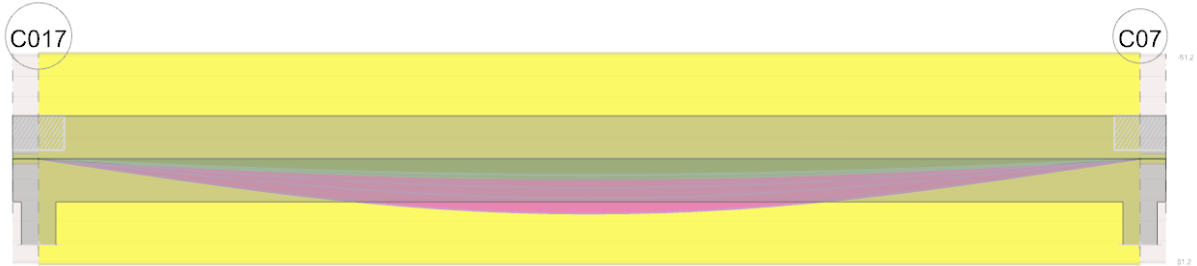
Fig. 66. Verifica grafica della freccia
