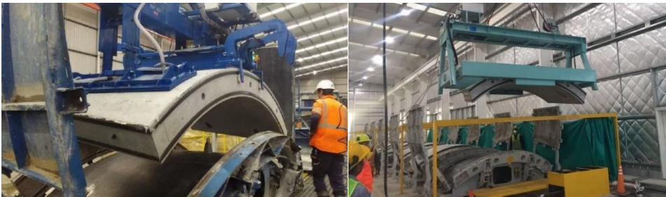
Figura 8-3: Schema tipologico di movimentazione (vacuum a sinistra, pinza meccanica a destra)
