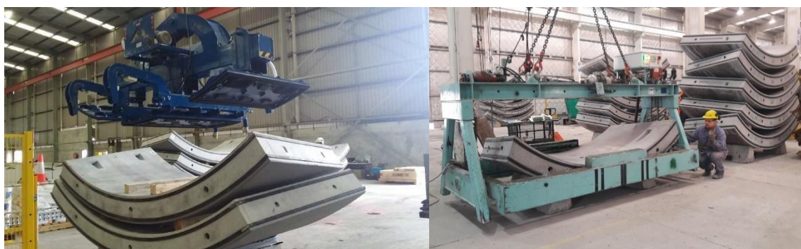
Figura 8-7: Sistema di movimentazione dei conci in stabilimento
