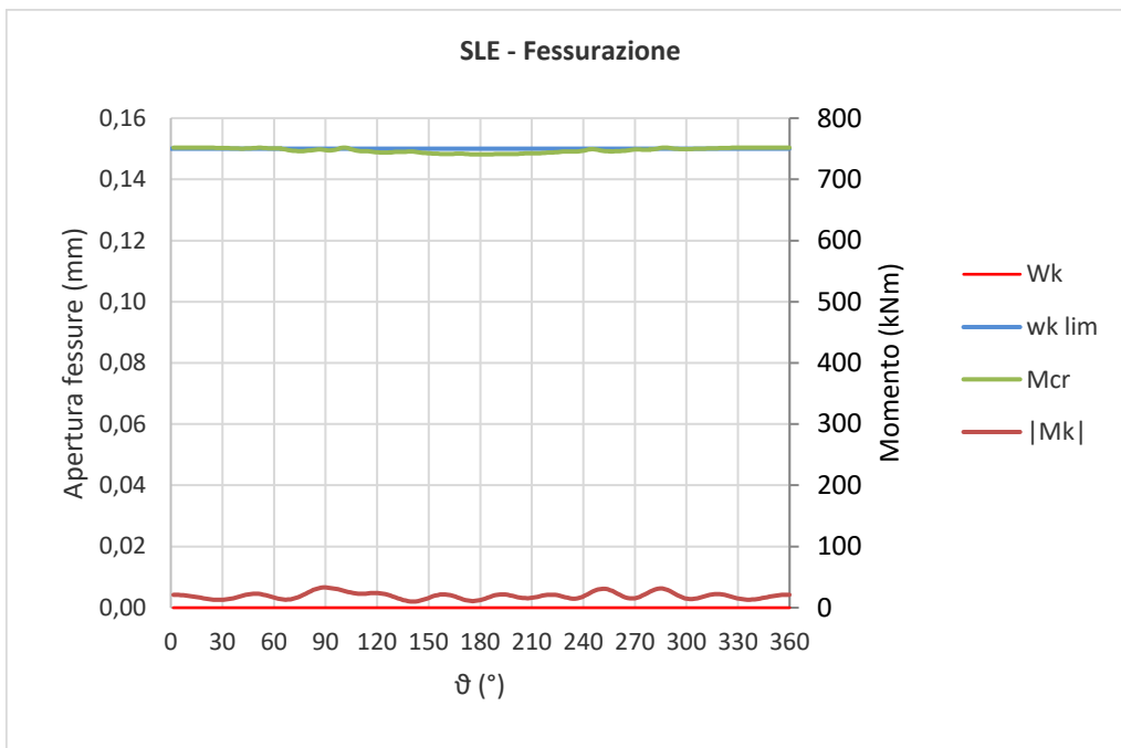
Figura 9-51: Stato di fessurazione Fase 3 - Sezione 6
