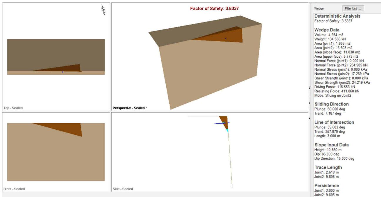
Fig. 47 – Analisi scivolamento cunei – sezione 17 H1 – intersezione critica K2-K7 condizione statica
