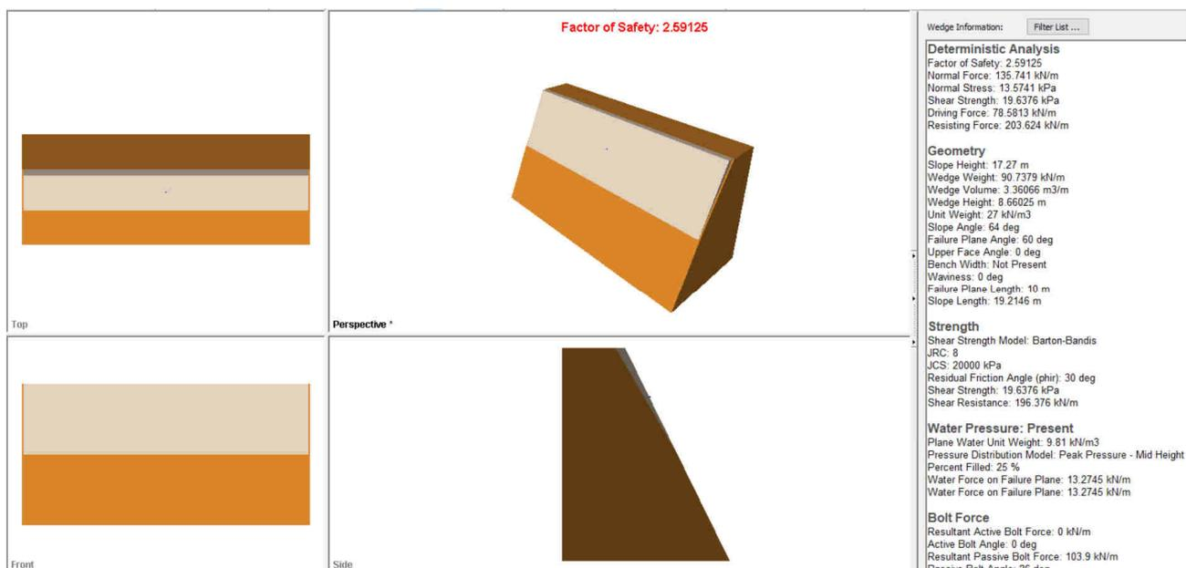
Fig. 71 – Analisi scivolamento planare – sezione 22 – Condizione statica
