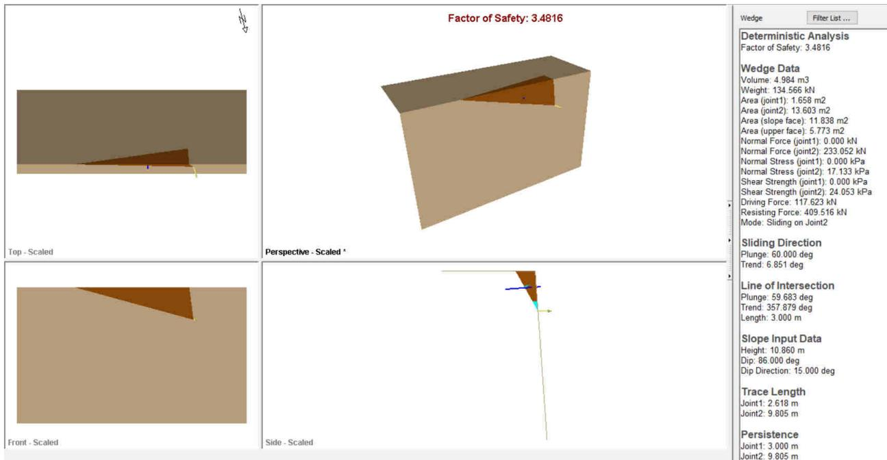
Fig. 51 – Analisi scivolamento cunei – sezione 17 H1 – intersezione critica K2-K7 condizione sismica
