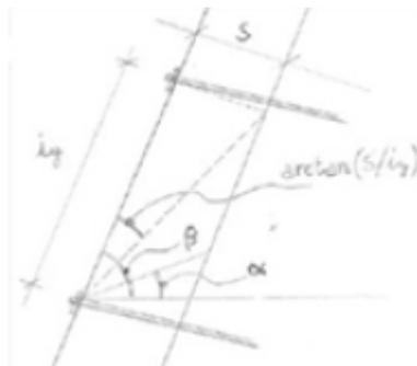
Fig. 29 - Geometria del volume di roccia tra gli ancoraggi
