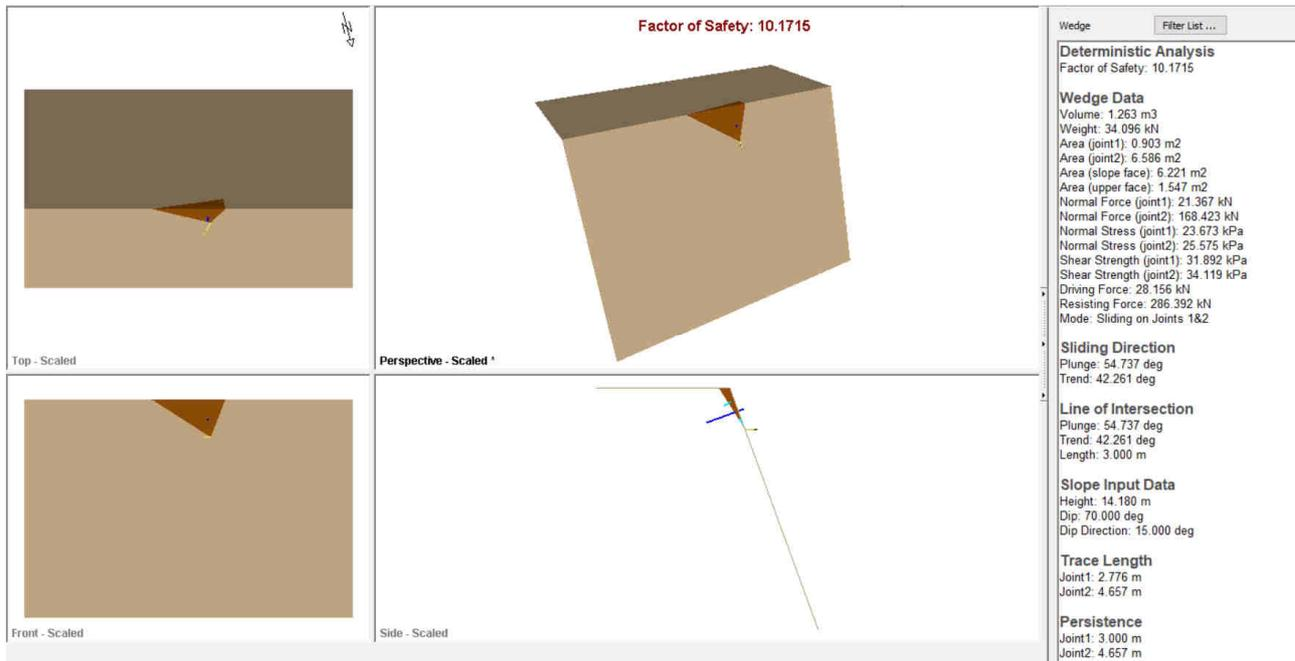
Fig. 54 – Analisi scivolamento cunei – sezione 17 H2 – intersezione critica K5-K7 condizione sismica
