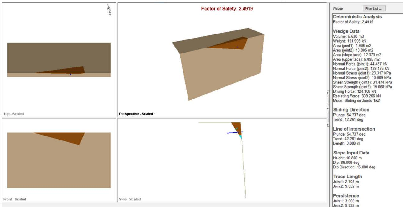
Fig. 49 – Analisi scivolamento cunei – sezione 17 H1 – intersezione critica K5-K7 condizione statica
