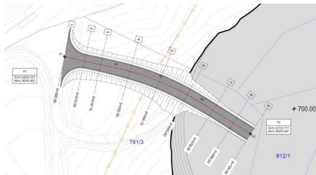
Fig. 5 – Viabilità di raccordo della sommità del deposito alla viabilità esistente – planimetria .
