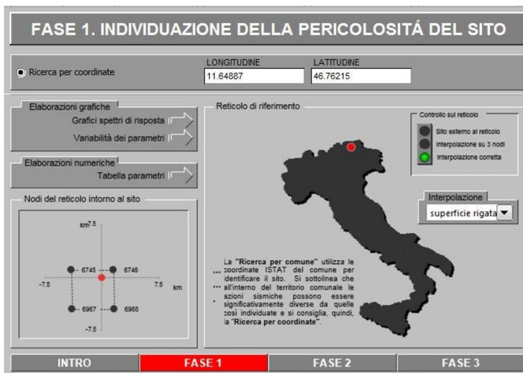
Figura 7-2 – Associazione dei punti di interesse, ai nodi della griglia di rappresentazione dei valori di pericolosità sismica secondo le tabelle allegate alle NTC2008.
