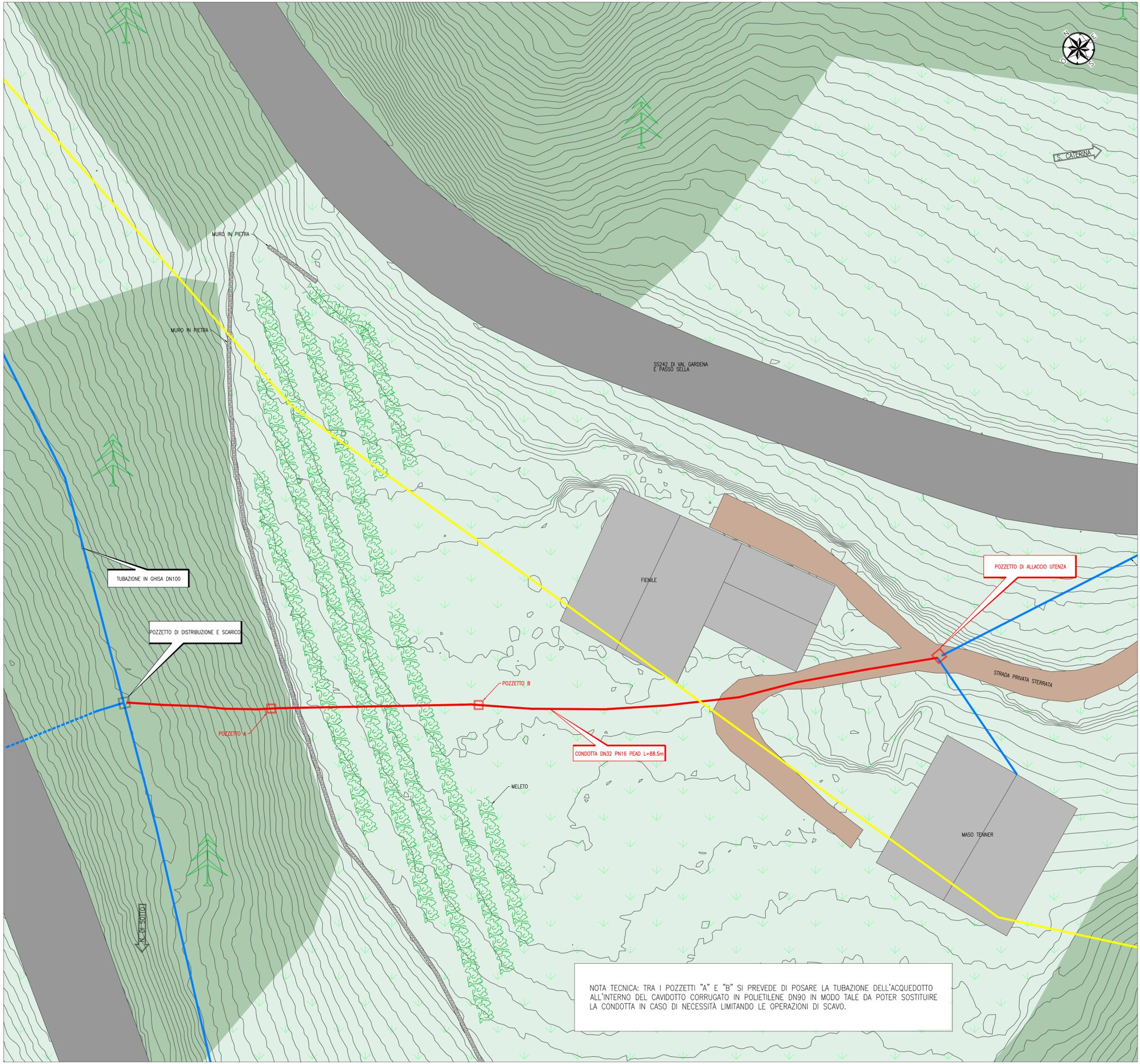
NOTA TECNICA: TRA I POZZETTI "A" E "B" SI PREVEDE DI POSARE LA TUBAZIONE DELL'ACQUEDOTTO ALL'INTERNO DEL CAVIDOTTO CORRUGATO IN POLIETILENE DN90 IN MODO TALE DA POTER SOSTITUIRE LA CONDOTTA IN CASO DI NECESSITÀ LIMITANDO LE OPERAZIONI DI SCAVO.
