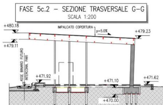
Figura 13. Sezione muro nuova copertura ingresso stazione
