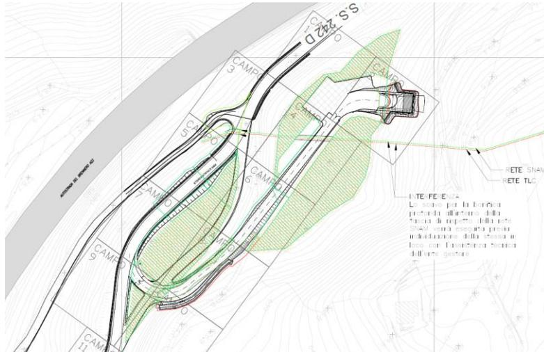
Per quanto riguarda l'area di Funes, invece è previsto in progetto lo spostamento della tubazione esistente con la realizzazione di un nuovo by-pass a valle dell'imbocco di progetto. Tale spostamento dovrà essere eseguito prima dell'inizio delle attività di bonifica. Nel caso in cui ciò non avvenga verrà eseguito lo scavo previa individuazione della tubazione in loco con l'assistenza tecnica dell'ente gestore
