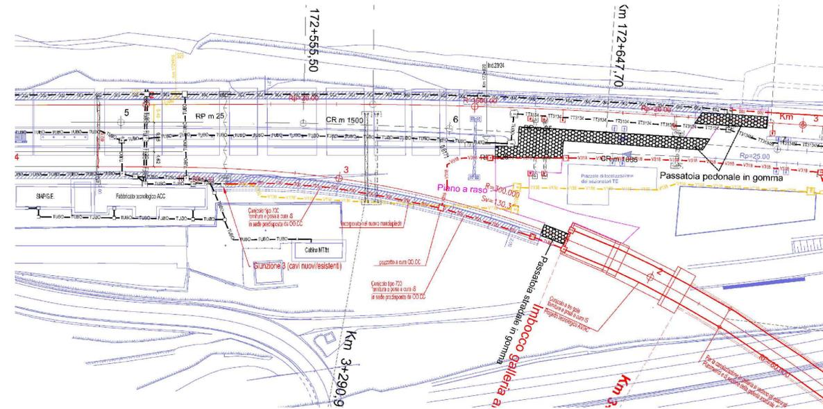
intercettazione cavi dorsale dispari per posa in nuova canalizzazione realizzata per liberare gli spazi per la Nuova Cabina TE Linea Storica
