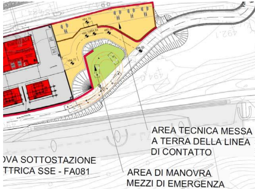
Figura - Area di manovra mezzi di emergenza
