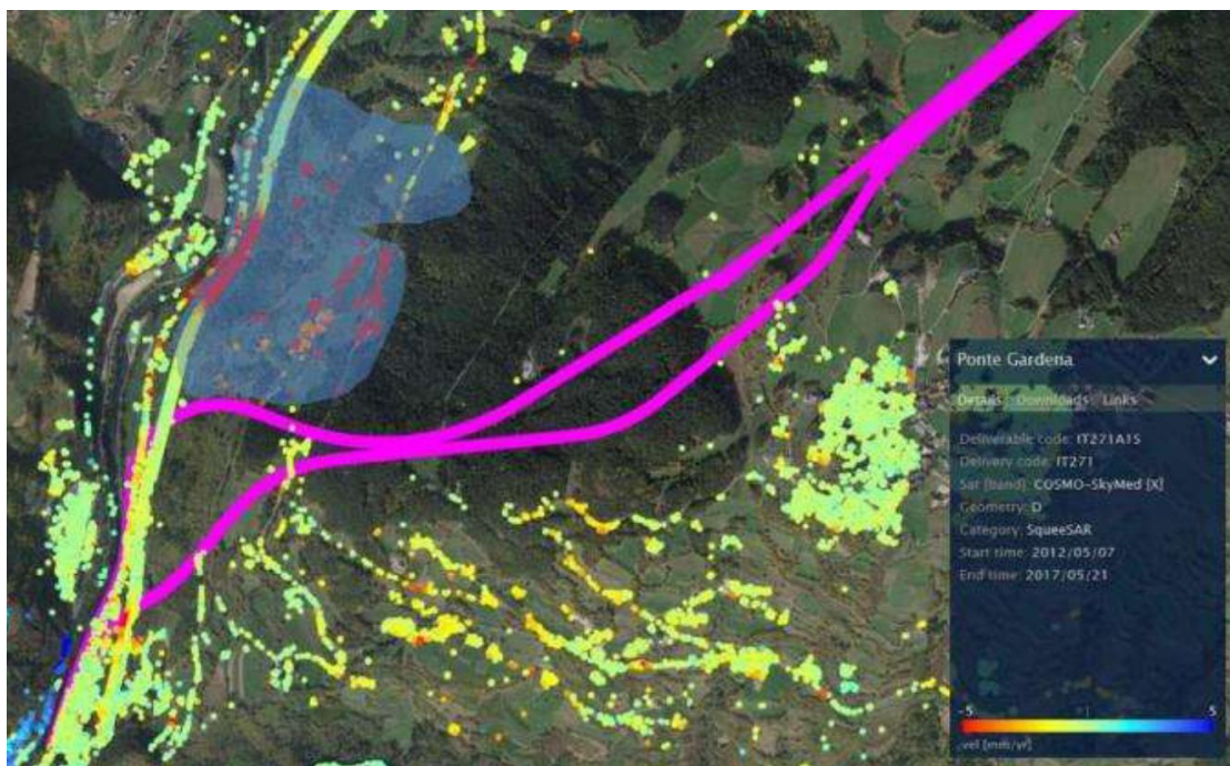
Fig 34: Dati dell'analisi satellitare 2012-2017 con ubicazione del tracciato delle interconnessioni definito dal PD e confermato dal Progetto Esecutivo (in viola) e del corpo di frana (in blu).
