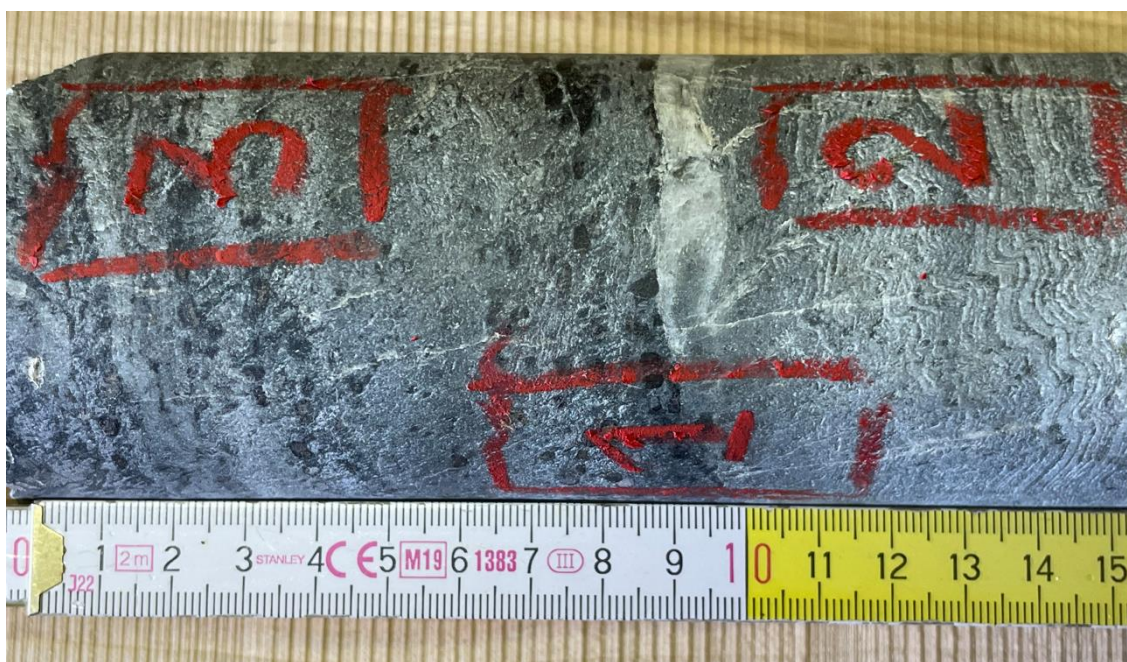
Fig. 94 – Campione di carota del sondaggio S21/4 con ubicazione delle sezioni sottili per analisi petrografica. Riferimenti: 0 cm = circa 121,6 m - cm = circa 121,75 m di profondità del sondaggio.
