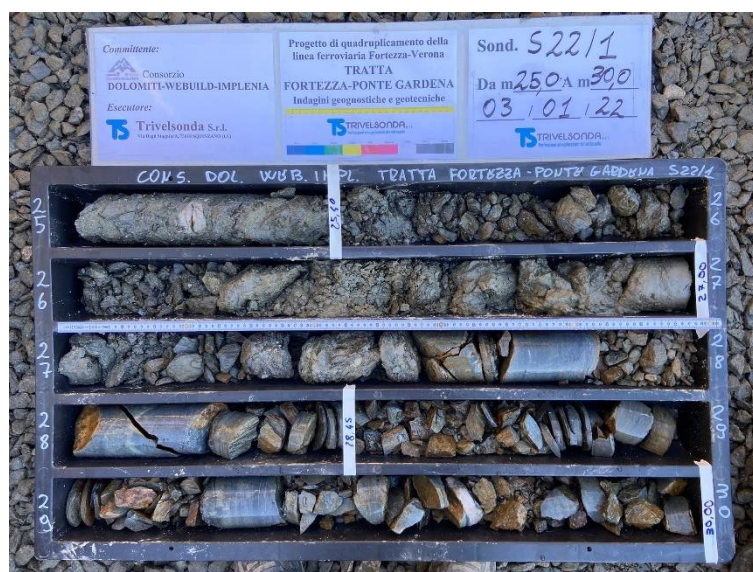
Figura 79 - Contatto litologico tra i depositi fluvio-glaciali ed il substrato filladico alla profondità di circa 27,55 m da pc (cassa 6, prof. 25-30 m).
