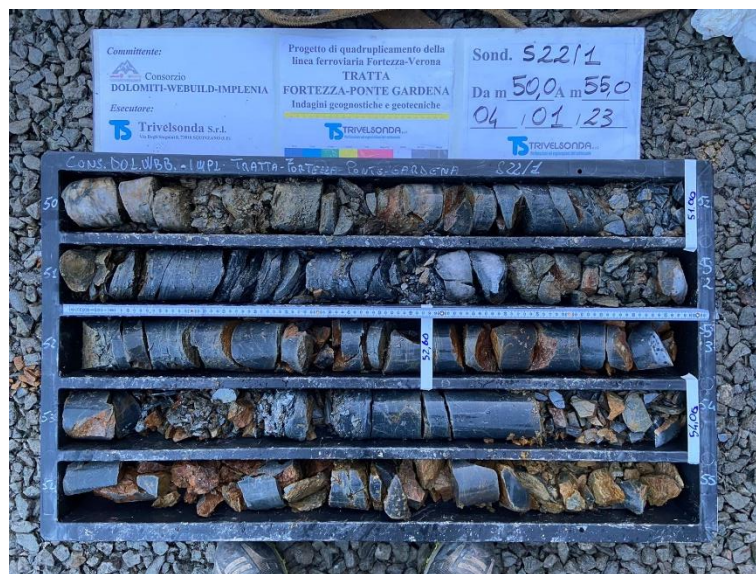
Figura 80 – Filladi fortemente fratturate; si noti l'alterazione ocra-bruno-rossastra delle superfici dei giunti (cassa 11, prof. 50-55).
