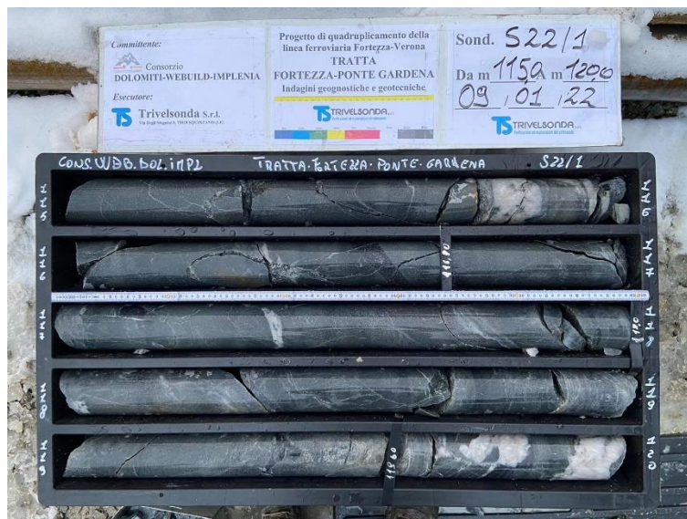
Figura 82 – Filladi poco fratturate localmente caratterizzate dalla presenza di vene di quarzo (cassa 24, prof. 115-120 m).
