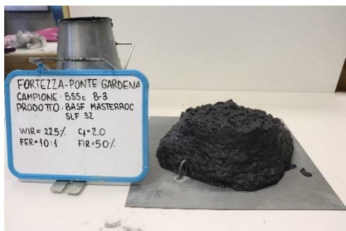
Fig. 44 – Esito della prova di slump del campione B-3 di BSSc.
