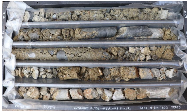
Fig. 14 – Esempio di cassetta catalogatrice contenente la formazione fi (Forch) dal sondaggio S21/4.
