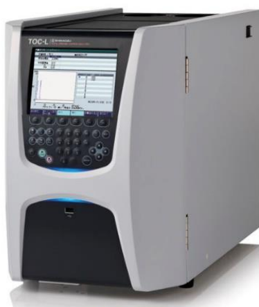
Fig. 50 - Apparecchiatura di misura per TOC.
