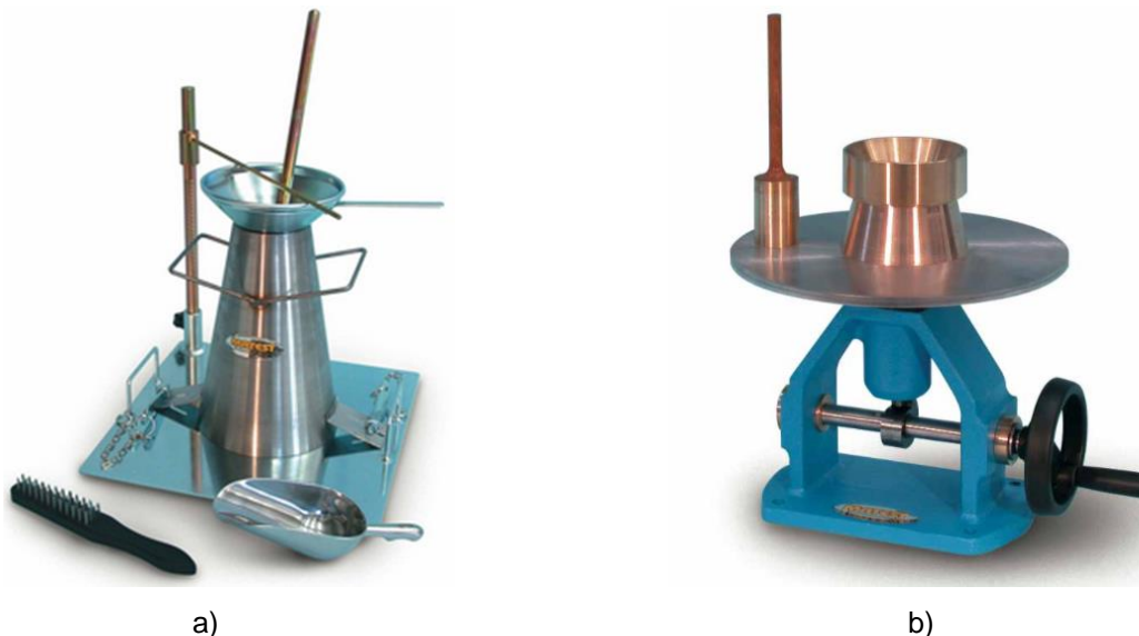
Fig. 7 – Cono di Abrams (a) e tavola a scosse (b).
