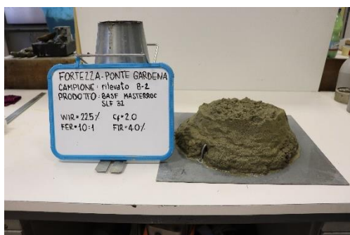
Fig. 35 – Esito della prova di slump del campione B-2 di h-d.
