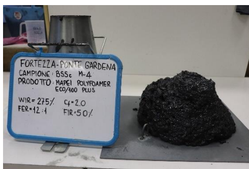
Fig. 43 – Esito della prova di slump del campione M-4 di BSSc
