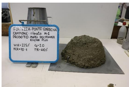
Fig. 34 – Esito della prova di slump del campione M-2 di h-d.
