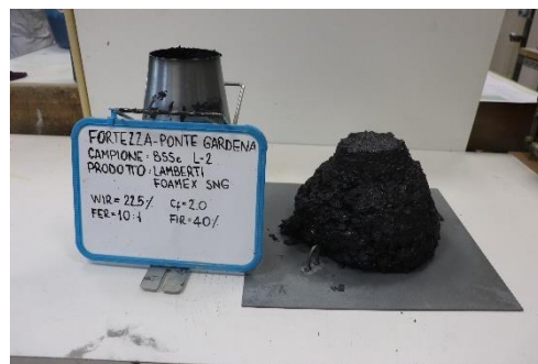
Fig. 45 – Esito della prova di slump del campione L-2 di BSSc.
