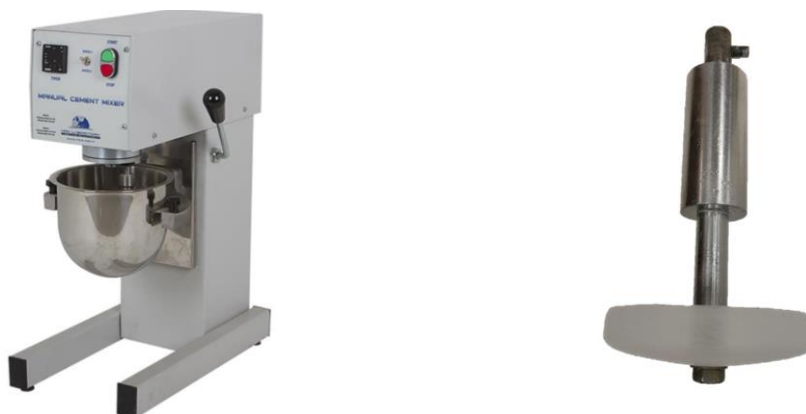
Fig. 8 – Miscelatore utilizzato per la prova di abrasione (sinistra) disco in plexiglass (destra).
