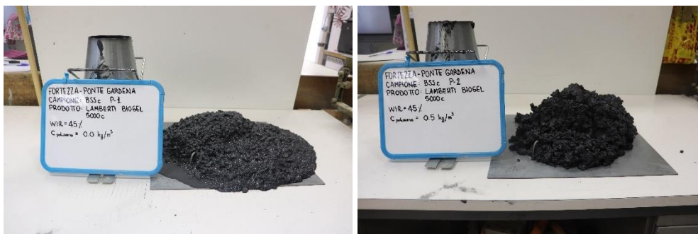
Fig. 49 – Esito della prova di slump del campione di BSSc prima e dopo l'aggiunta del polimero.
