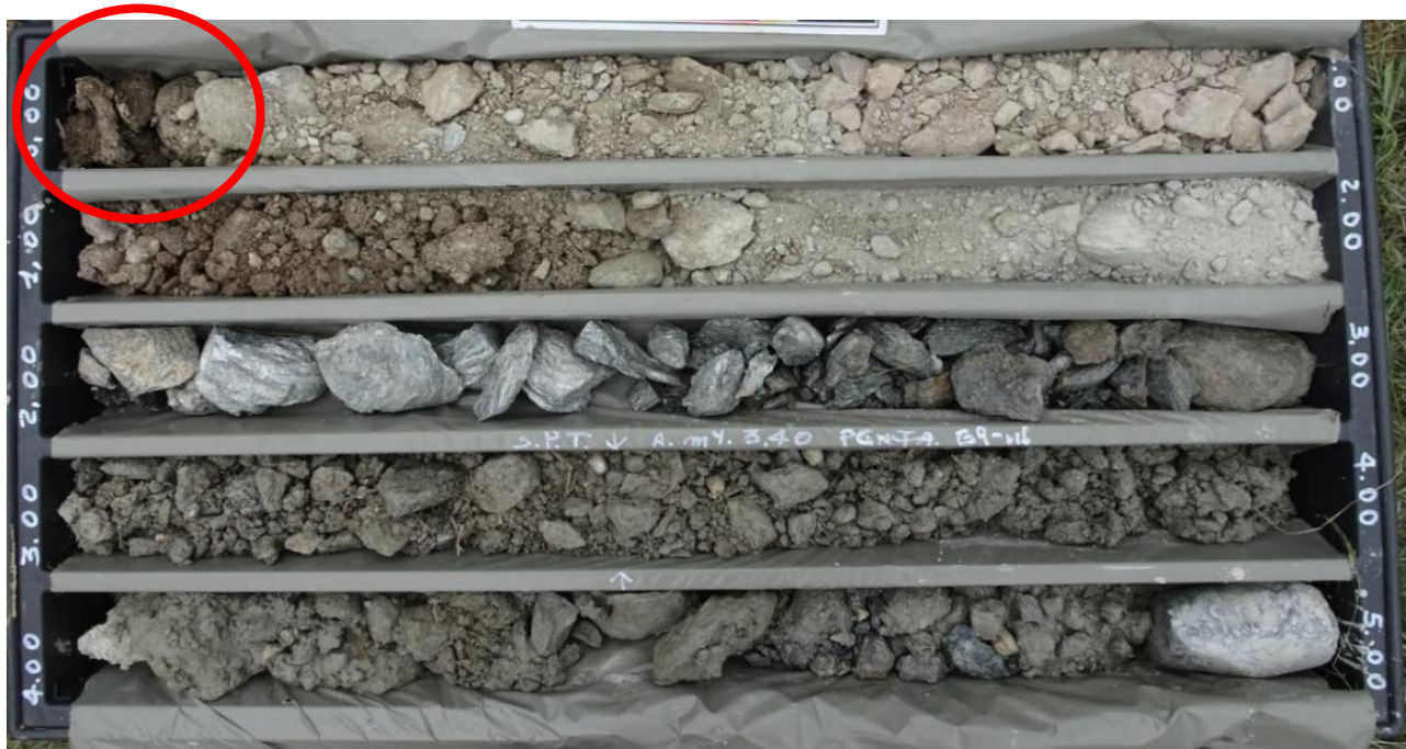
Figura 7-18 – Prima cassetta del sondaggio EO24 della zona di Ponte Gardena. Il circolo rosso indica il sottilissimo strato di terreno vegetale.
