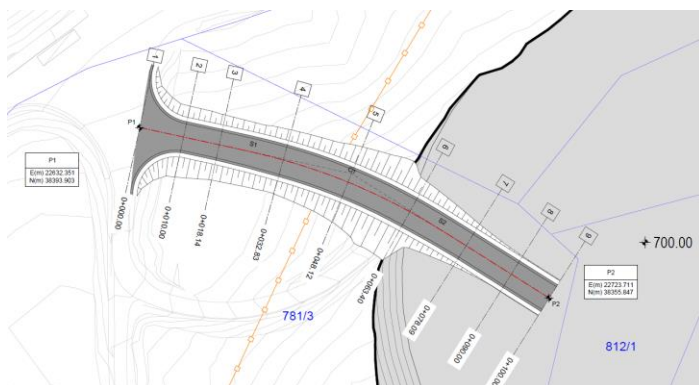
Figura 17-15 Viabilità di raccordo della sommità del deposito alla viabilità esistente.
