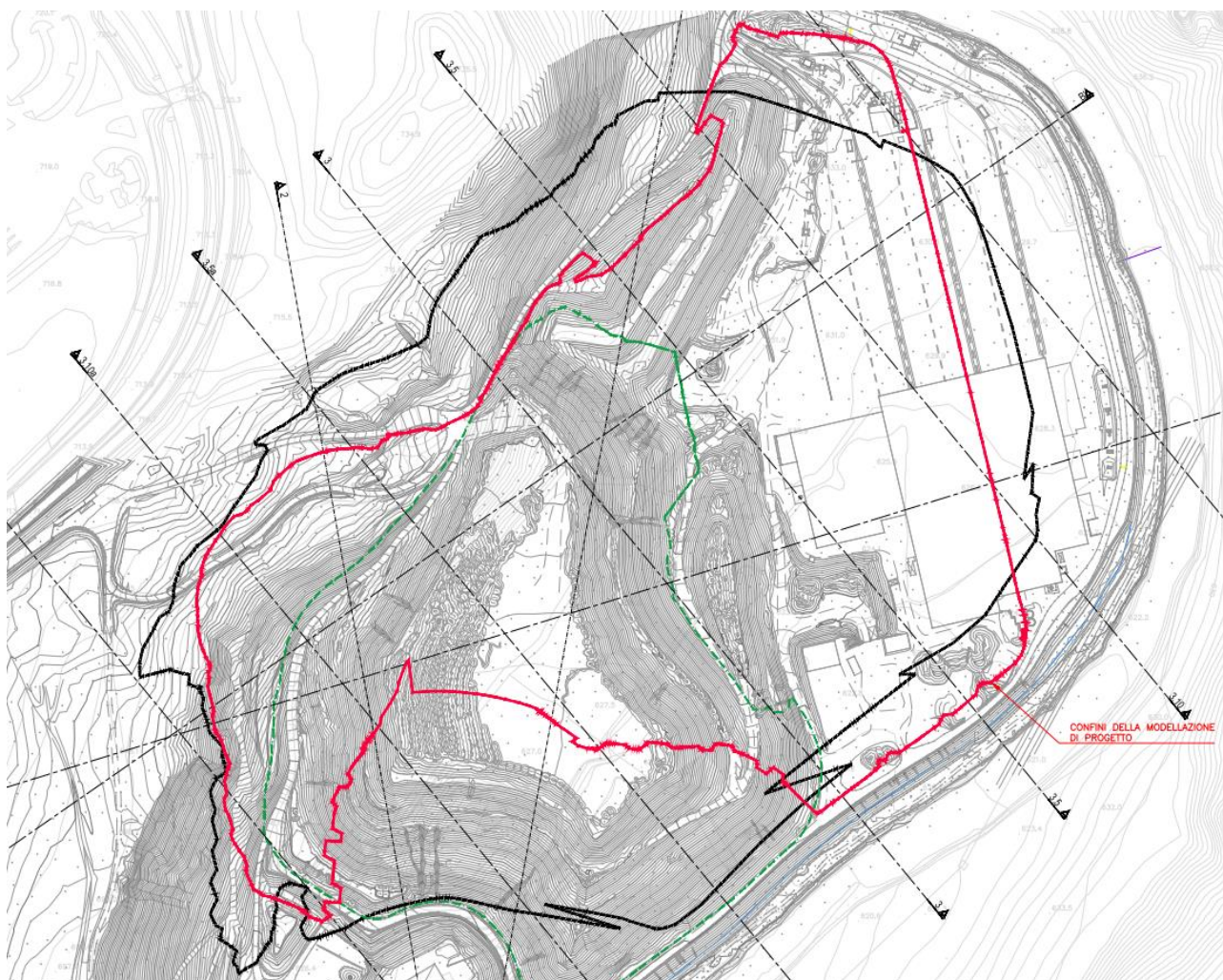
Figura 6-37 Confronto degli ingombri planimetrici del deposito Hinterigger fra soluzione di PD (contorno nero), perimetro BTC (contorno verde) e perimetro finale studiato in fase di PE (contorno rosso)
