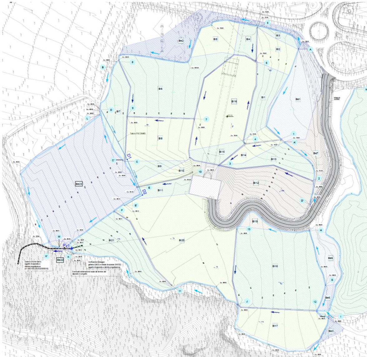
Figura 6-19- Planimetria idraulica d'intervento per il deposito di Forch
