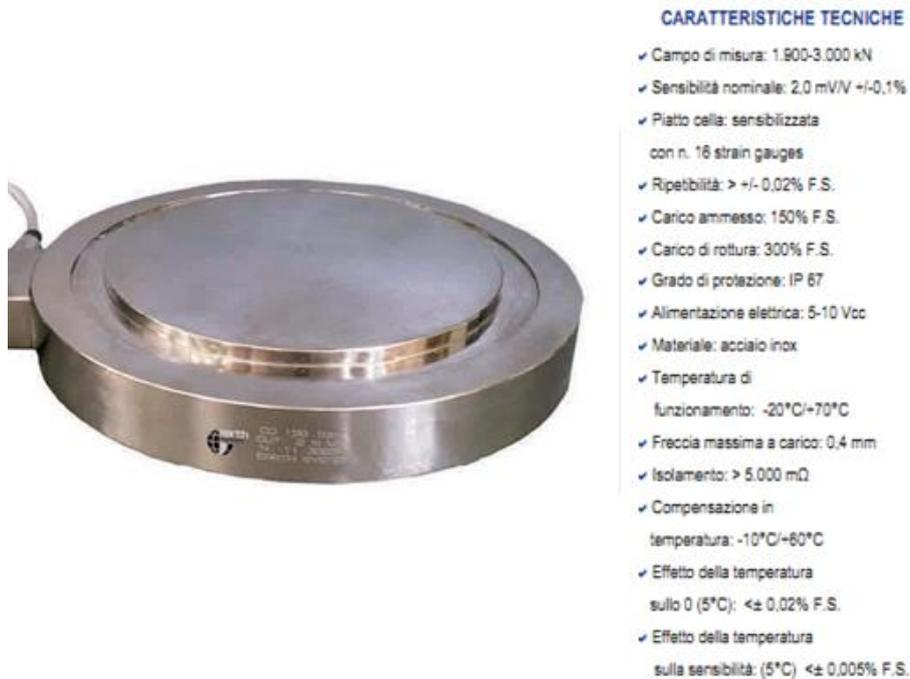
Fig. 3 – Caratteristiche tecniche delle celle di carico
