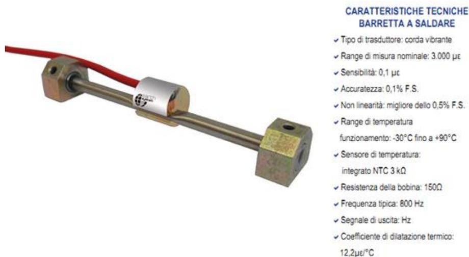
Fig. 2 - caratteristiche tecniche delle barrette estensimetriche per prerivestimento
