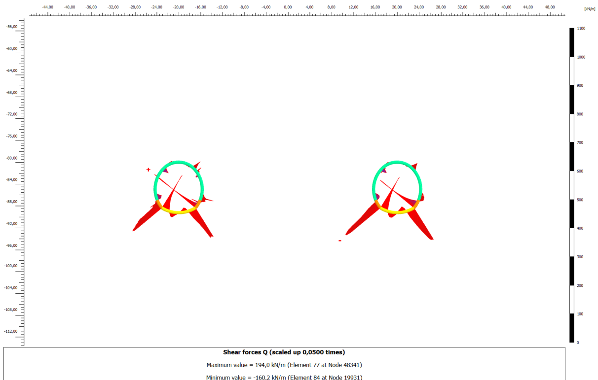
Figura 9-15: Involuppo di sforzo di taglio agente sul rivestimento definitivo - Sezione Tipo A0bis
