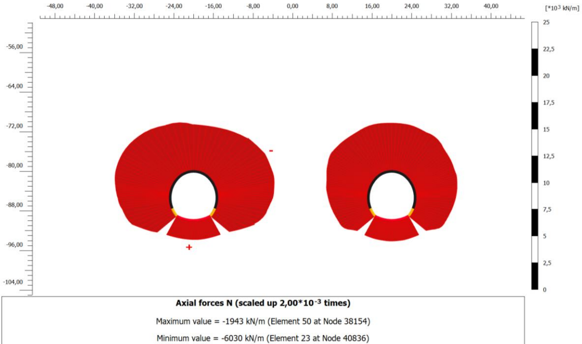
Figura 9-119: Involuppo di sforzo normale agente sul rivestimento definitivo - Sezione Tipo C2V
