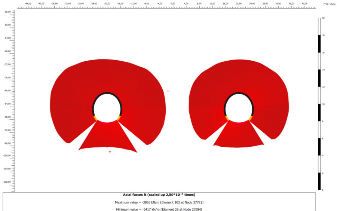
Figura 9-108: Involuppo di sforzo normale agente sul rivestimento definitivo - Sezione Tipo C2L
