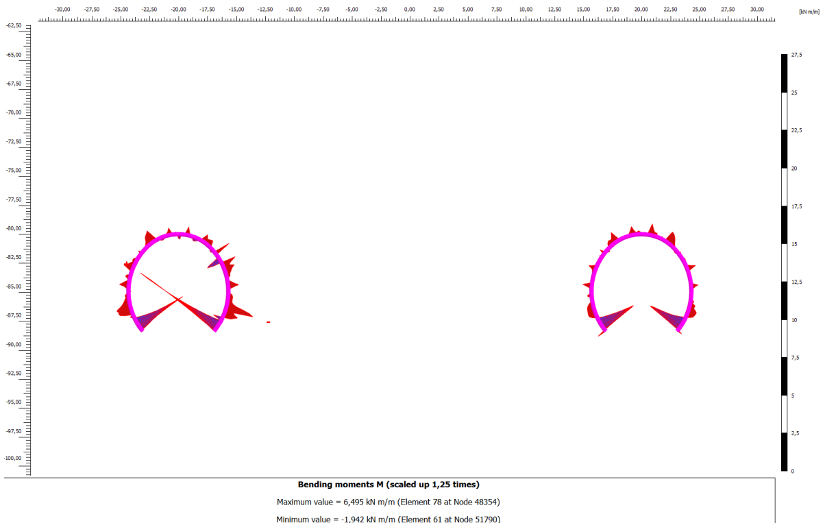
Figura 9-11: Momento flettente agente sul rivestimento provvisorio - Sezione Tipo A0bis
