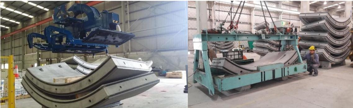
Figura 8-7: Sistema di movimentazione dei conci in stabilimento
