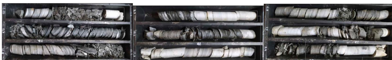
Fig. 14 – esempio di carote estratte da perforatrice TBM
