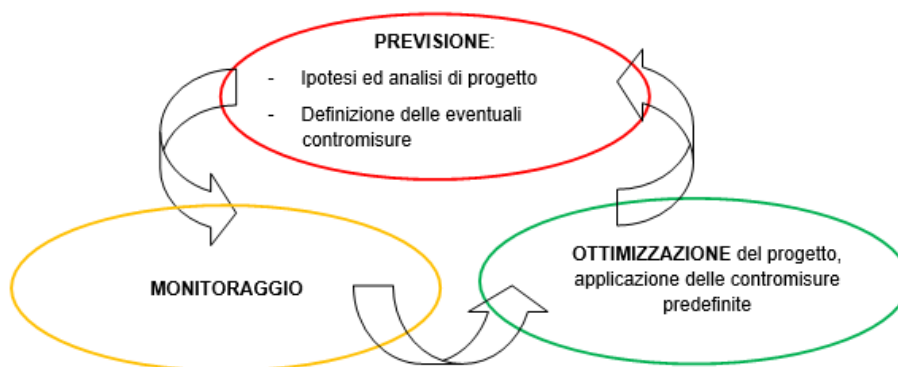
Fig. 5-1 Diagramma di flusso relativo alla metodologia di progettazione osservazionale
