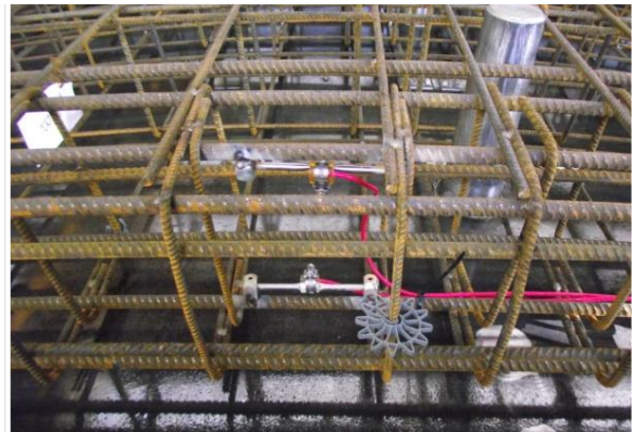
Fig. 2 – Estensimetri saldati all'armatura e installazione all'intradosso del cono
