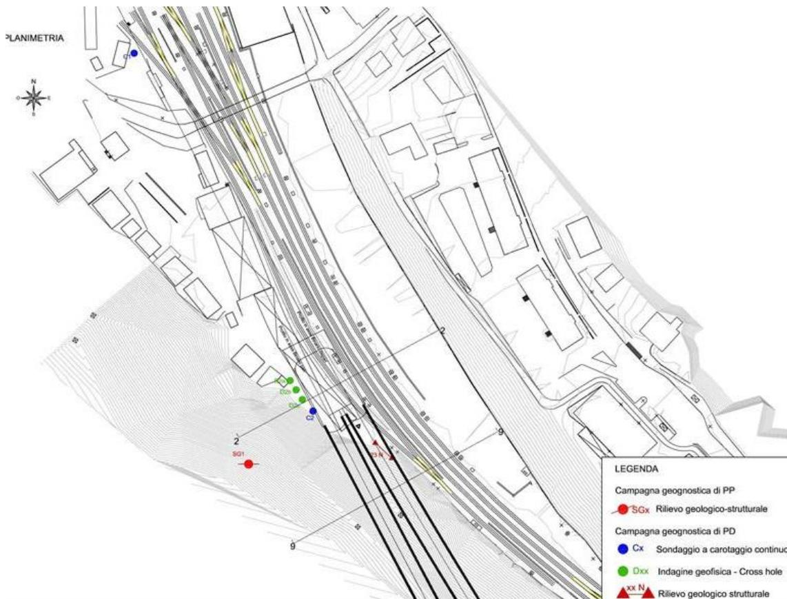
Figura 7-1 Ubicazione delle indagini geognostiche eseguite nella zona di interesse dell'imbocco..
