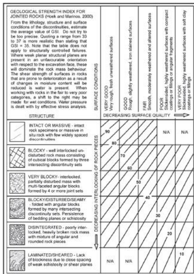
Figura 7-3 Stima dell'indice GSI sulla base della descrizione geologica dell'ammasso (Hoek e Marinos, 2000).
