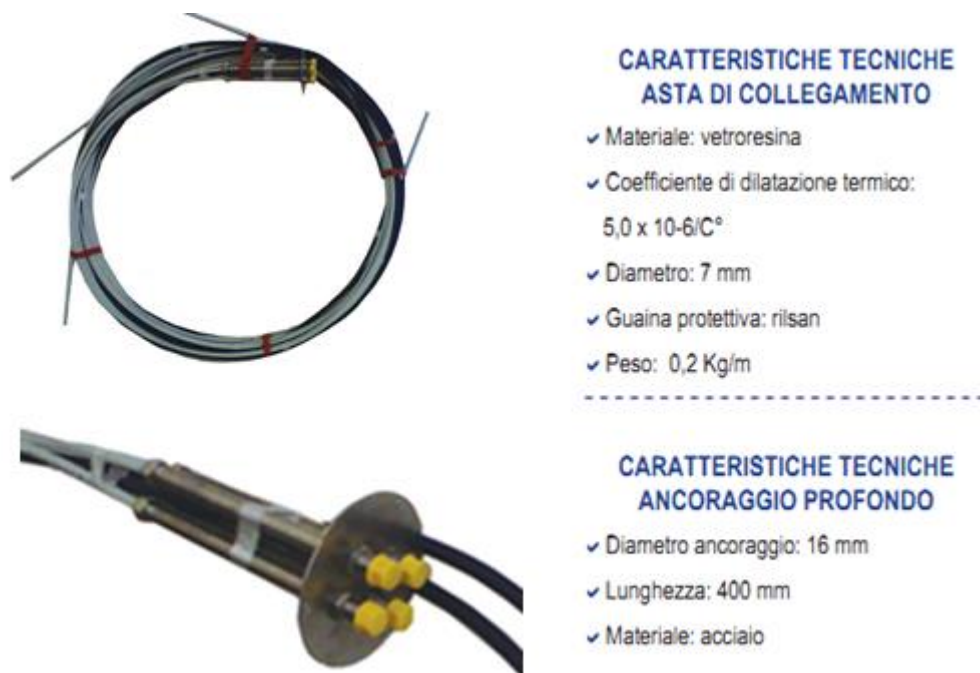
Figura 3. Caratteristiche tecniche degli estensimetri multibase
