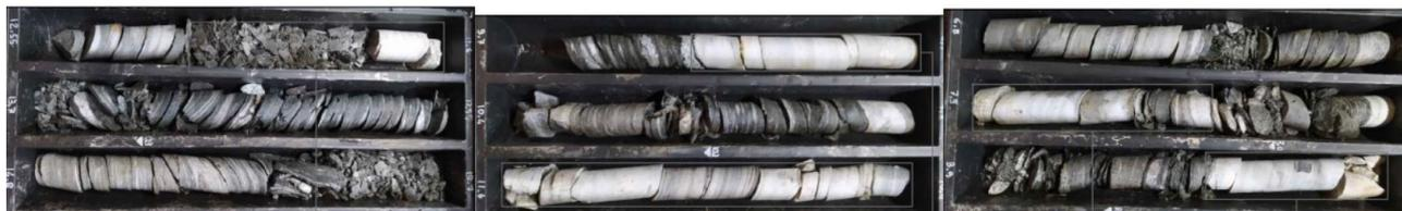
Fig. 10 – esempio di carote estratte da perforatrice TBM
