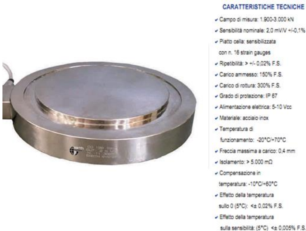
Fig. 5 – Caratteristiche tecniche delle celle di carico
