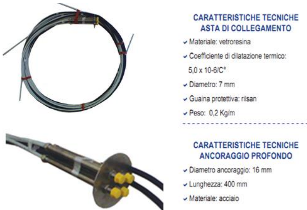
Fig. 1 - Caratteristiche tecniche degli estensimetri multibase
