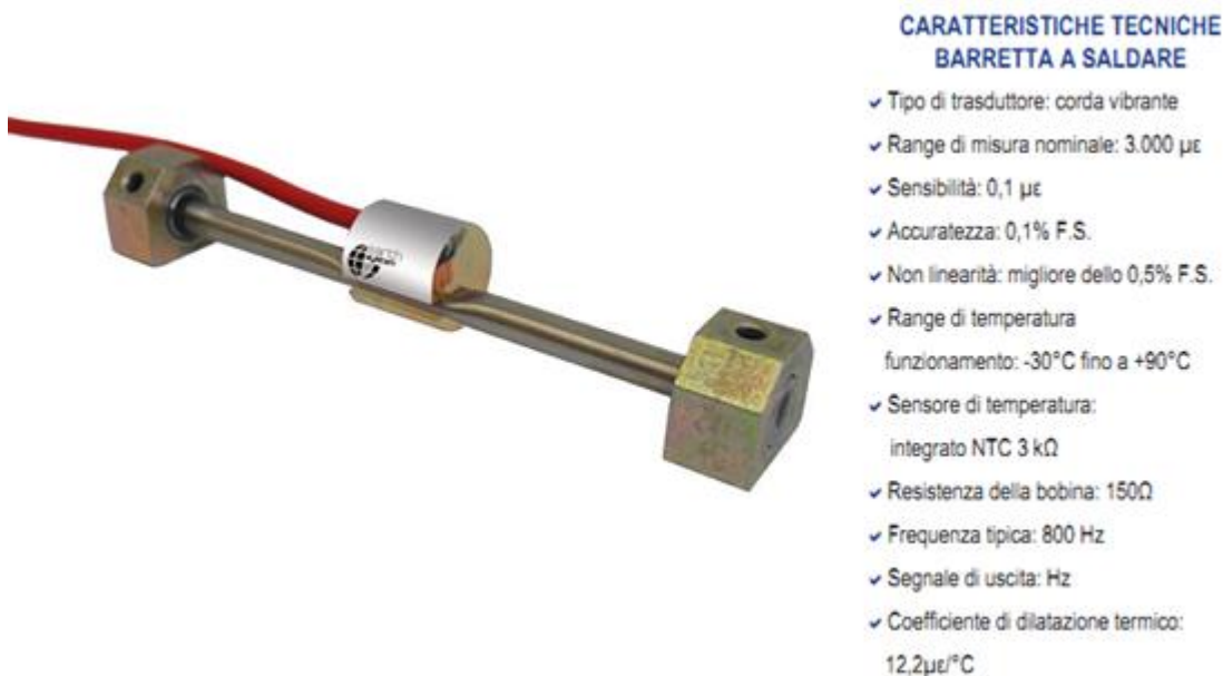
Fig. 4 - caratteristiche tecniche delle barrette estensimetriche per prerivestimento
