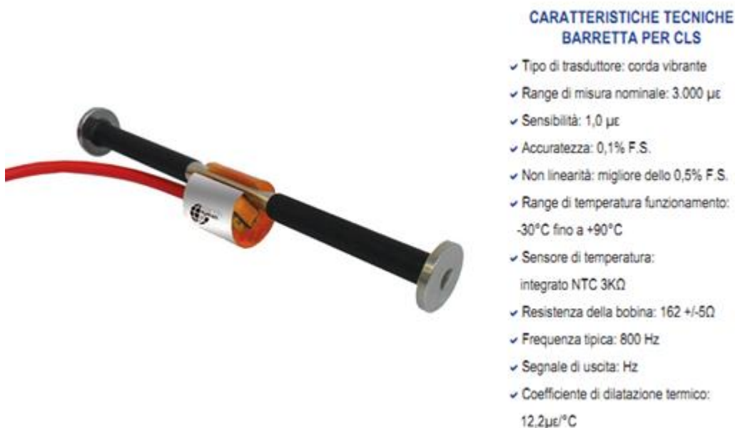
Fig. 6 – Caratteristiche tecniche delle barrette estensimetri per rivestimento definitivo
