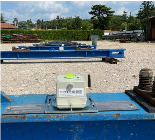
Figura 6 - Clinometro monoassiale con piastra di regolazione e livella
