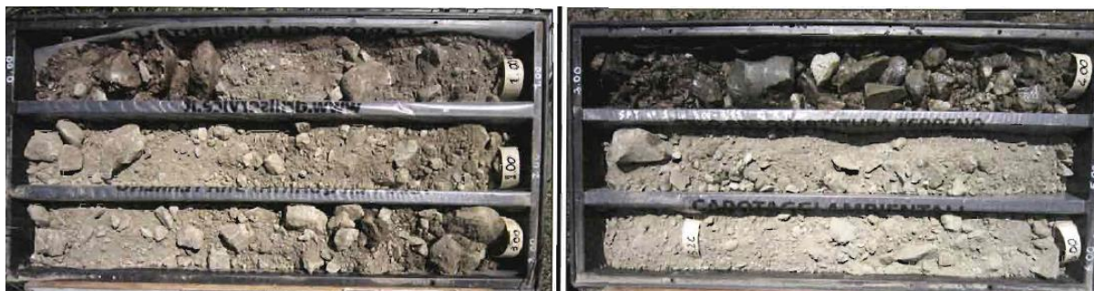
Foto delle cassette dei sondaggi E014, C22, C7 nella zona del Ponte Isarco di progetto
