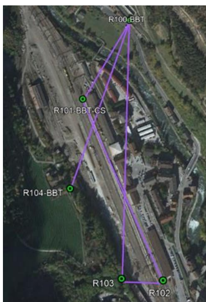
Fig.8 Rete Raffittimento R100 – R104
