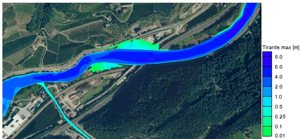
Figura 24 – Stato di cantiere scenario 1, tiranti idraulici per una piena Tr 30 anni.
