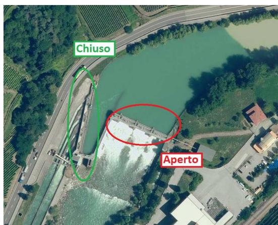
Figura 7 – Configurazione simulata per l'opera di presa dell'impianto idroelettrico di Barbiano – Ponte Gardena. In rosso sono indicate le paratoie di settore, in verde le bocche di presa.
