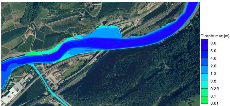
Figura 37 - Tiranti massimi in occasione di una piena con Tr 500 anni allo stato di progetto.
