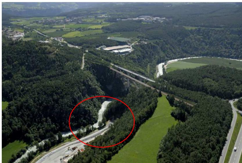
Figura 22. Il tratto in destra orografica a monte del viadotto sul Fiume Isarco in cui è atteso un deflusso a piene rive per TR 500 anni.
