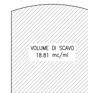
SEZIONE DI SCAVO SCALA 1:100 NICCHIA TECNOLOGICA - SEZIONE TIPO B
