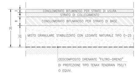
SEZIONE TIPOLOGICA STRADA IN RILEVATO
