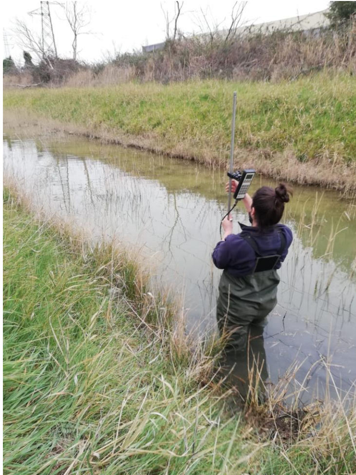
Figura 8 - Realizzazione delle misure di portata
