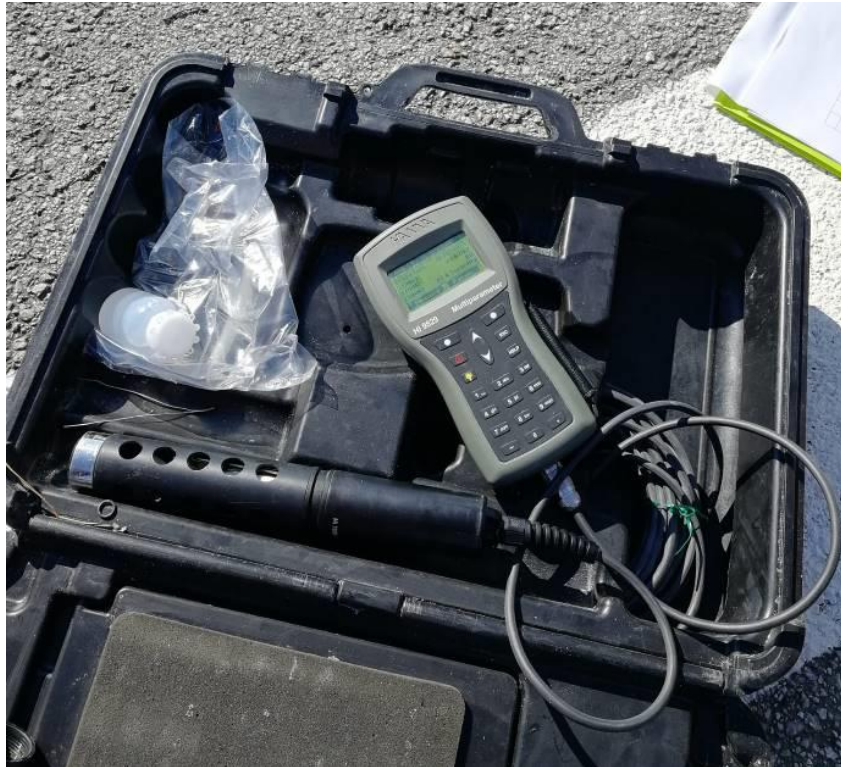
Figura 7- Sonda multi-parametrica utilizzata per il monitoraggio dei parametri in campo
