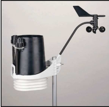
Figura 8 Esempio di stazione meteo
