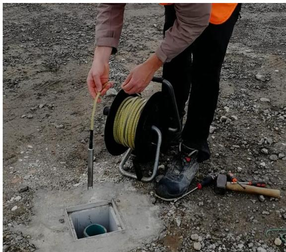
Figura 10 Utilizzo del freatimetro per la misura del livello piezometrico
