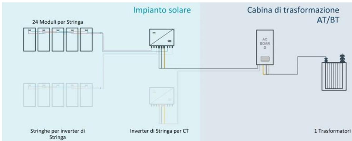
Figura 5-1: schema di configurazione elettrica semplificata
