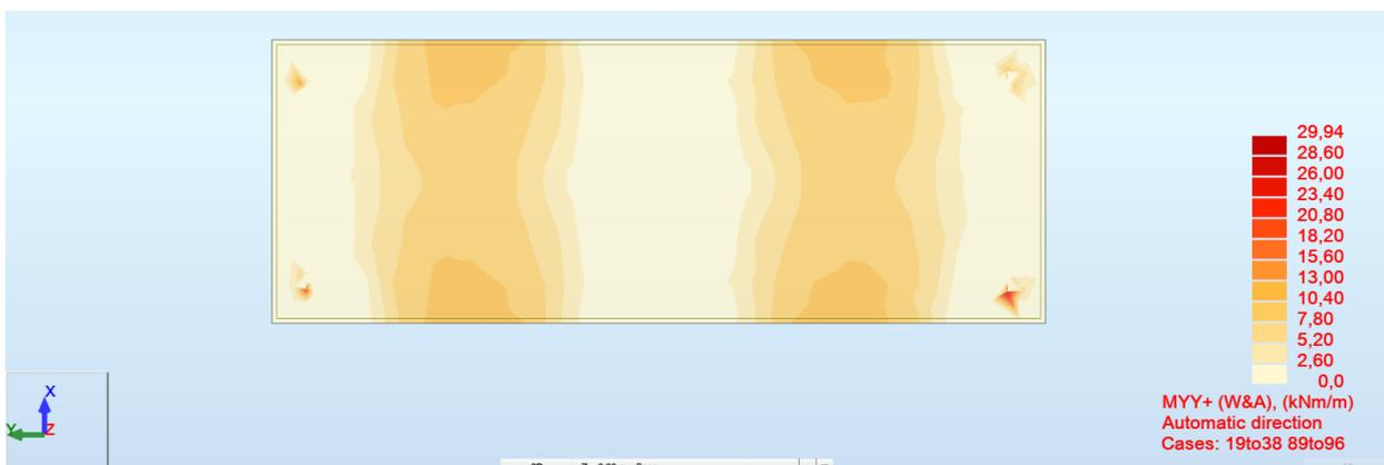
FIG. 30 – INVILUPPO SUPERIORE MOMENTO FLETTENTE (WOOD&ARMER) DIREZIONE Y
