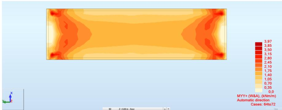
FIG. 42 – INVILUPPO SUPERIORE MOMENTO FLETTENTE (WOOD&ARMER) DIREZIONE Y
