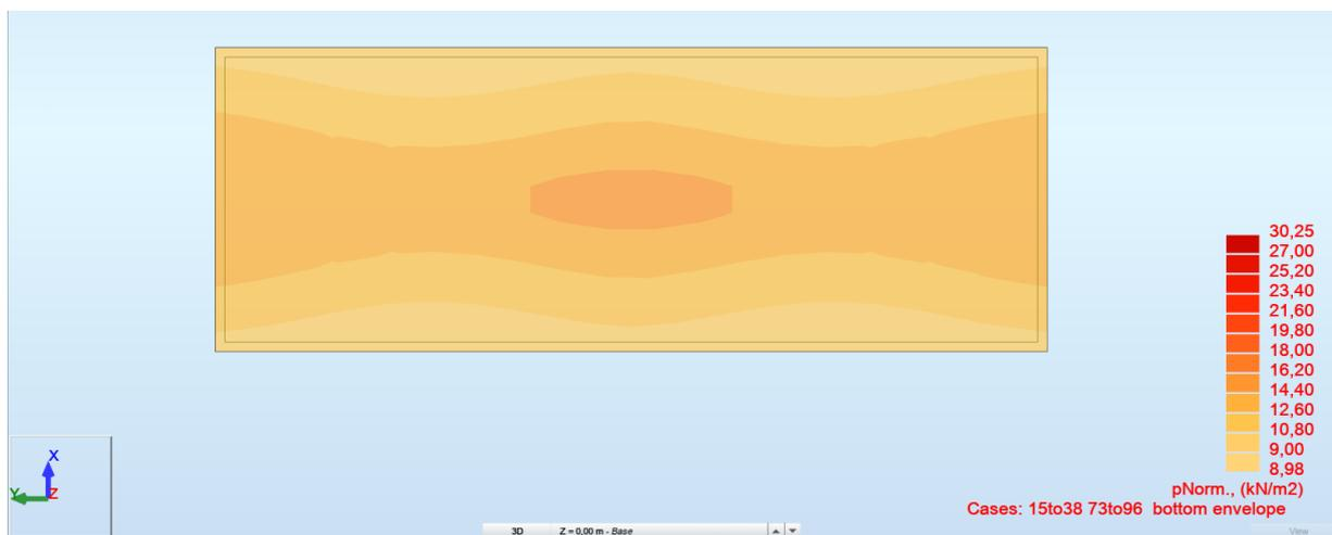
Fig. 37 – Ribaltamento – Involuppo Combinazioni SLU (EQU) – Fondazione – Cabina di Trasformazione
