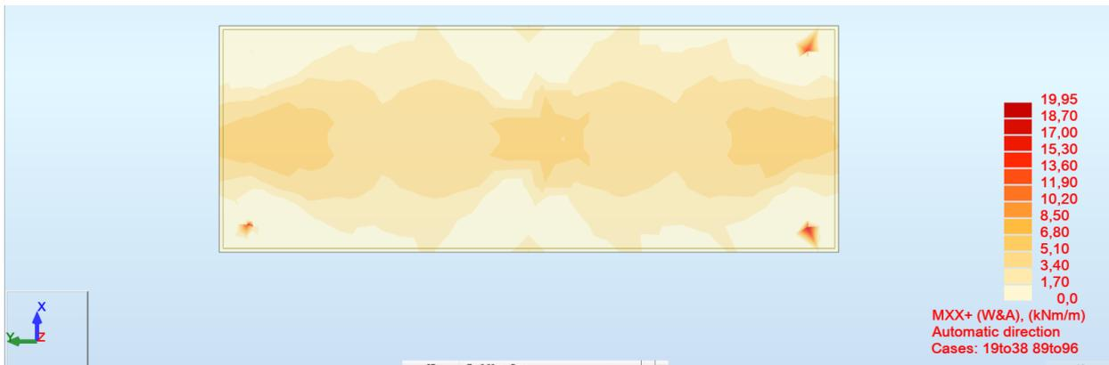
FIG. 29 – INVILUPPO SUPERIORE MOMENTO FLETTENTE (WOOD&ARMER) DIREZIONE X
