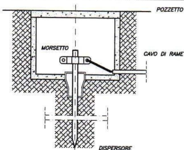
Figura 4-1 dispersore di terra con pozzetto ispezionabile
