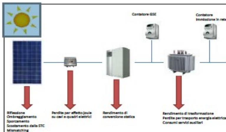
La complessità oggettiva di rilevare e quantificare gli effetti di determinate perdite di sistema (ad esempio: mismatch, ombreggiamenti, sporcizia sulla superficie dei moduli), fa sì che il "PR" venga rilevato come confronto tra l'energia teoricamente producibile (funzione dell'irraggiamento e della temperatura) e quella effettivamente prodotta nel medesimo periodo di osservazione.
