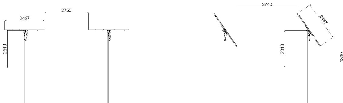
Figura 4. Copertura dei moduli fotovoltaici.
