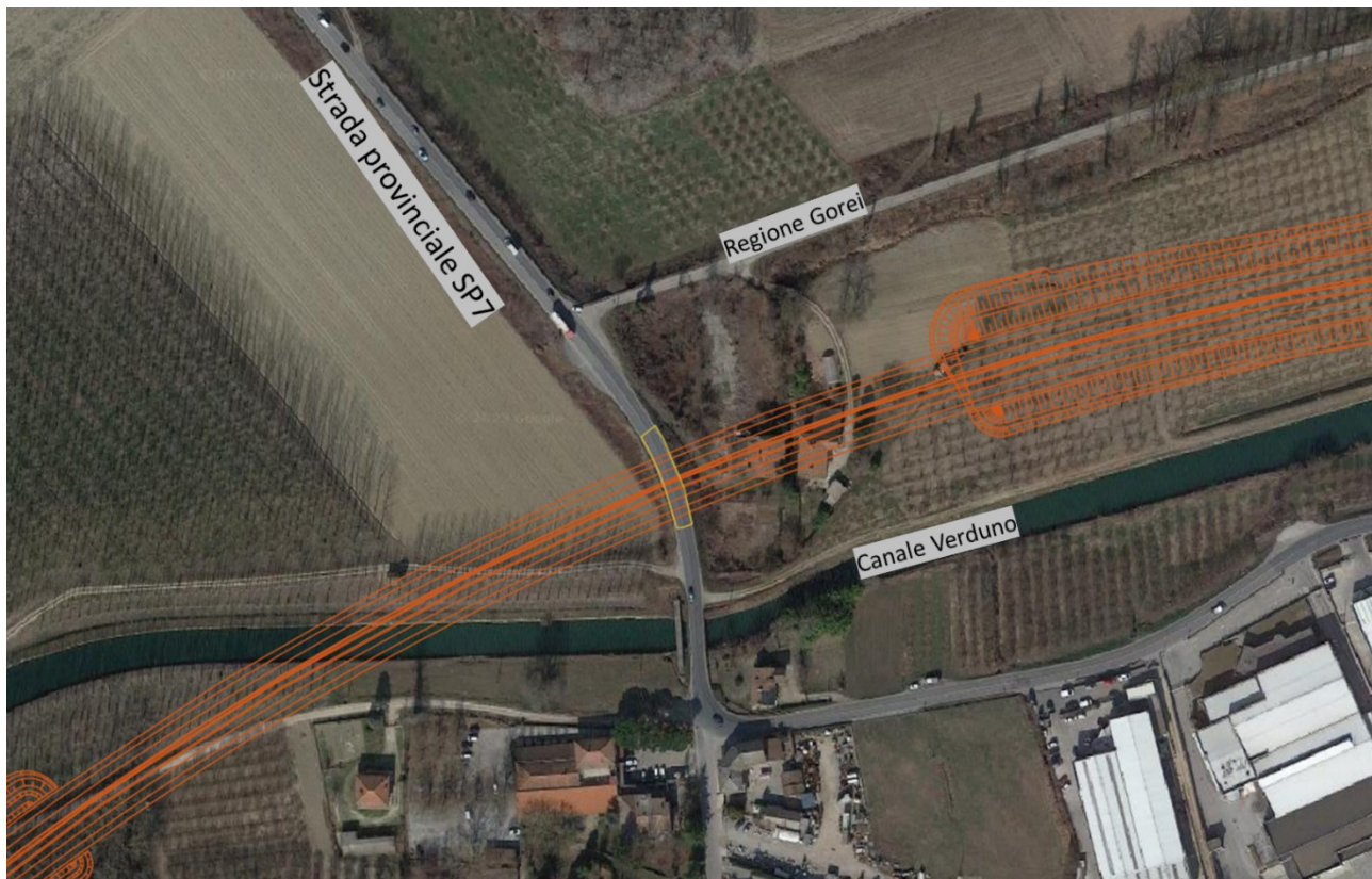
Figura 29 – Rilevato d'accesso al ponte sul Tanaro della S.P. 7 che interagisce con il rilevato stradale. È indicata in giallo la localizzazione della breccia lungo il rilevato.
