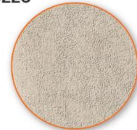
DETTAGLIO TEXTURE SABBIAIATURA DEL CALCESTRUZZO
