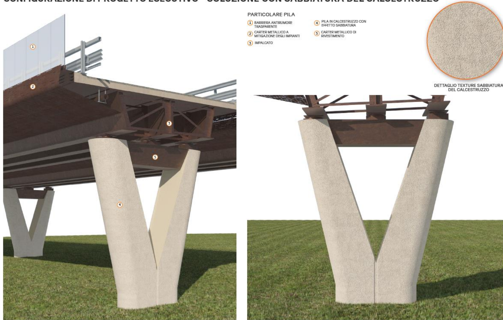
Figura 3-1 Soluzione con sabbiaura del calcestruzzo per le pile del viadotto SP7
