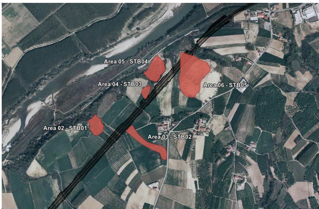
Figura 3-48 Visualizzazione delle aree instabili in cui sono previsti gli interventi di stabilizzazione
