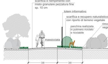
SCHEMA SEZIONE PISTA CICLABILE IN PROGETTO: RILEVATO, TRINCEE
