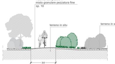
SCHEMA SEZIONE PISTA CICLABILE IN PROGETTO
