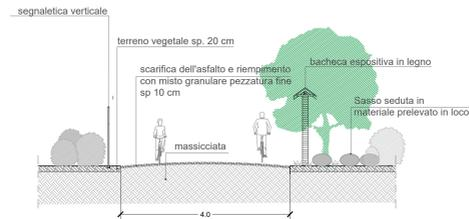
SCHEMA SEZIONE PISTA CICLABILE IN PROGETTO
