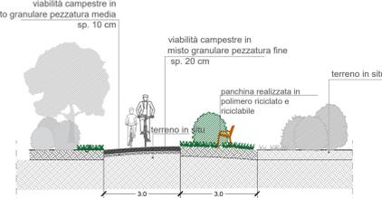
SCHEMA SEZIONE PISTA CICLABILE IN PROGETTO
