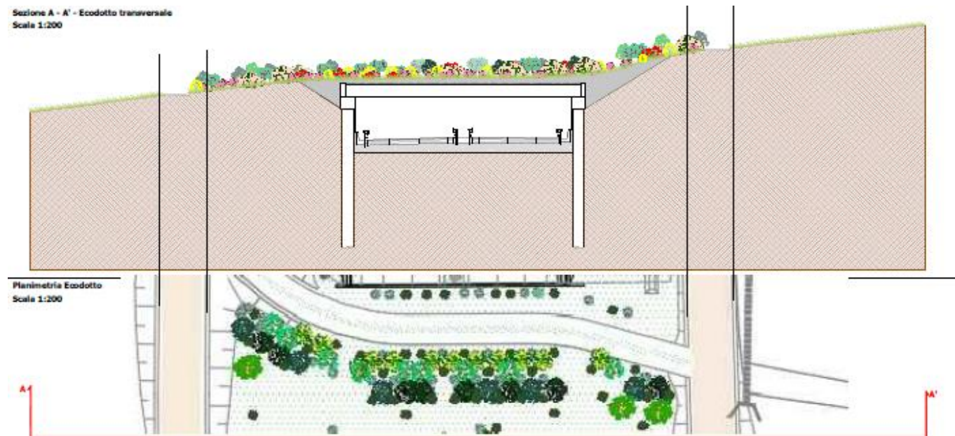
Figura 3-6 Sezione trasversale dell'ecodotto
