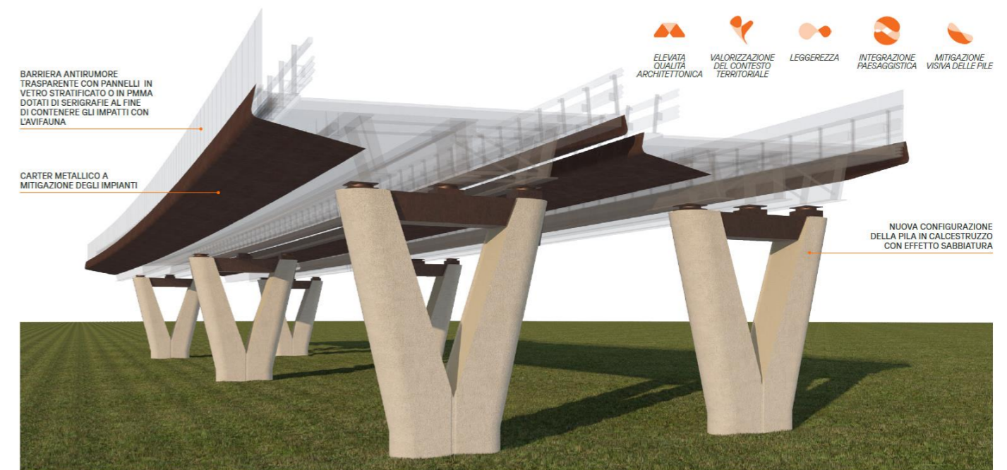
FIGURA 4-2 PROPOSTE DI OTTIMIZZAZIONE STRUTTURALE DEL PROGETTO ESECUTIVO
