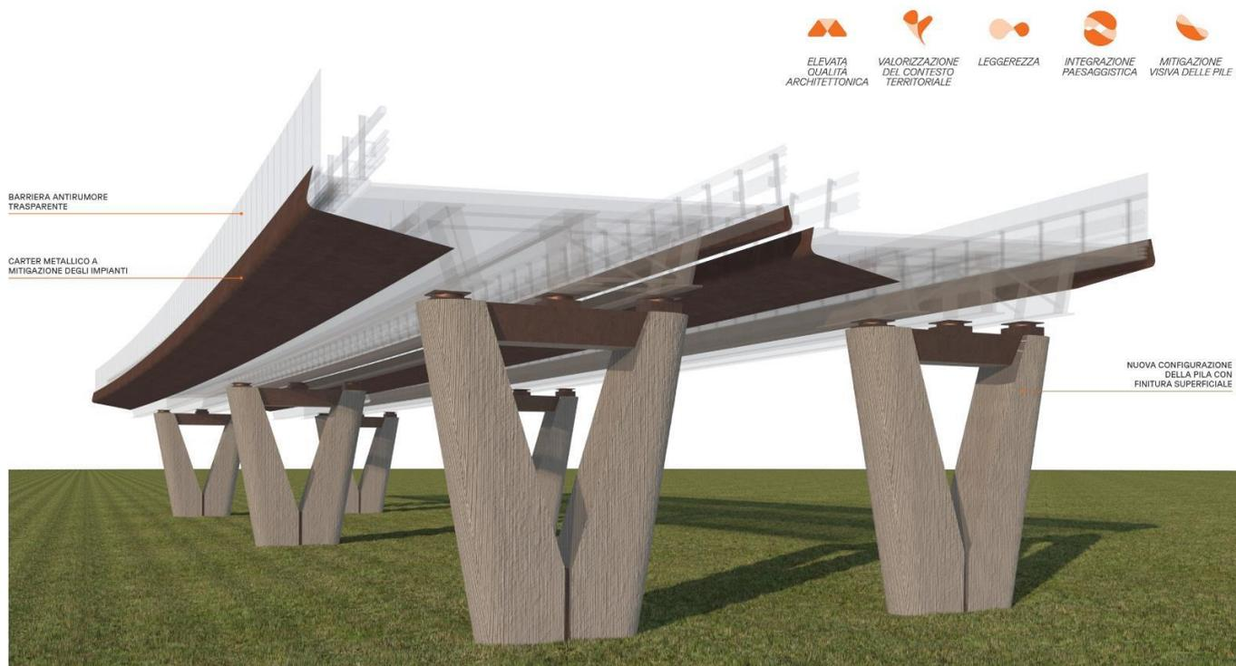
*Figura 4-25 Proposte di ottimizzazione strutturale del progetto esecutivo*
