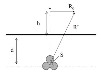
In accordo con la norma CEI 106-11, per la posa in questione, con singola terna di cavi all'interno del cavidotto, si procede applicando la formula semplificata per il calcolo diretto della distanza  $R_0$  dall'asse della linea al livello del suolo (h=0) oltre la quale l'induzione magnetica scende al di sotto del valore di  $3~\mu T$ .
