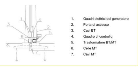
Come possibile vedere dalla soprastante immagine, ogni aerogeneratore è solitamente composto da specifiche componenti elettriche poste all'interno dello stesso.
